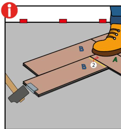
Anschließend stellen Sie sich auf die A-Planken. Klopfen Sie nun mit einem Hammer (kein Gummihammer) gegen den Schlagklotz der B-Planke. Klopfen Sie solange bis die Dielen fest miteinander verbunden sind.
