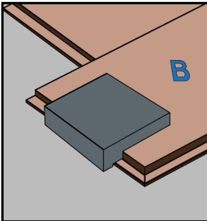
Legen Sie vor der B-Planke einen Schlagklotz. Der Schlagklotz sollte oberhalb der Lippe platziert werden, sodass die Klick-Verbindung nicht beschädigt wird.
