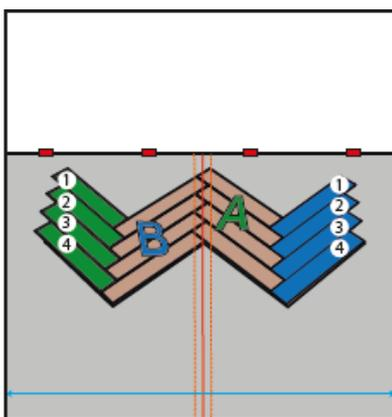
Entsprechend der Kennzeichnungen „A“ und „B“ verlegen Sie ausgehend von den acht verlegten Dielen links und rechts weitere Planken (siehe Abbildung).
