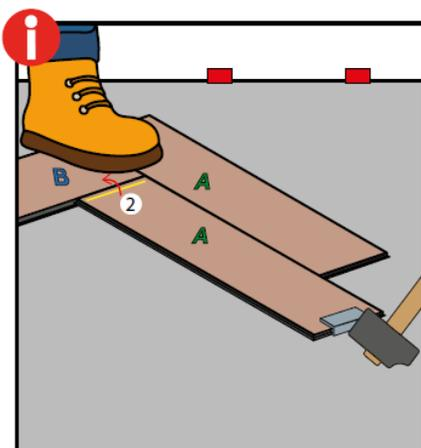
Anschließend stellen Sie sich auf die B-Planke. Klopfen Sie nun mit einem Hammer (kein Gummihammer) gegen den Schlagklotz der A-Planke. Klopfen Sie solange bis die Dielen fest miteinander verbunden sind.
