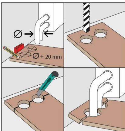
Wo beispielsweise Heizungsrohre aus dem Boden ragen, bitte zuerst das Paneel auf die richtige Länge zuschneiden, dann das Paneelstück neben den eigentlichen Platz legen und die Aussparungen mit dem Zollstock abmessen und anzeichnen.
