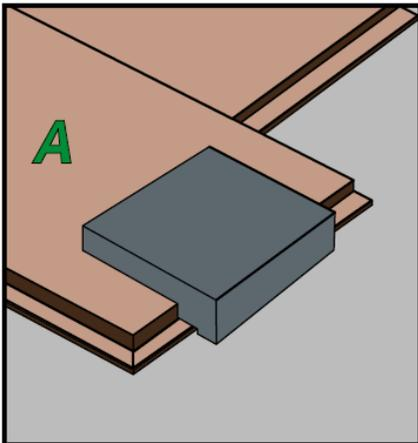
Legen Sie vor der A-Planke einen Schlagklotz. Der Schlagklotz sollte oberhalb der Lippe platziert werden, sodass die Klick-Verbindung nicht beschädigt wird.
