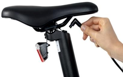
Si vous voulez charger la batterie séparément, dévissez la sécurité du port de branchement au contrôleur, desserrez le collier de selle, et retirez la tige de selle dans son intégralité. Répéter les étapes ci-dessus pour la replacer et la connecter.
