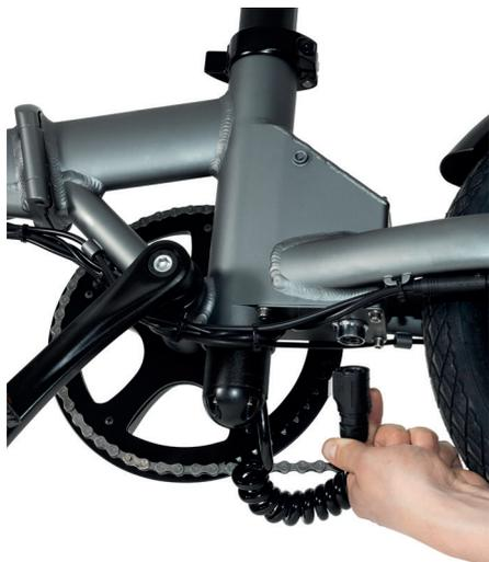
Pour brancher la batterie au contrôleur, il vous faudra clipser le port de branchement, se trouvant au bout de la batterie, au port de branchement du contrôleur qui lui se situe sous le vélo.
