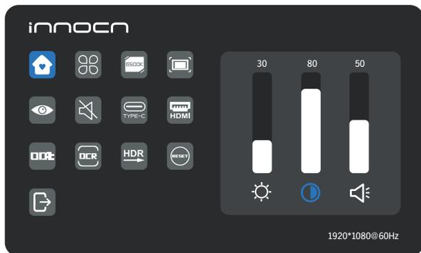
アップキーとダウンキーで明るさ、コントラスト、音量を調整します
