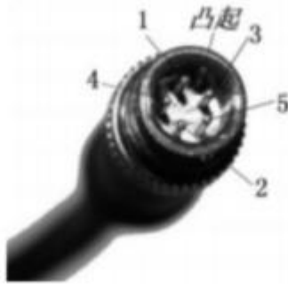
Meter outlet end
