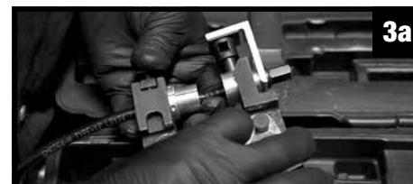
Pour fixer le tuyau souple de carburant en nylon, vous aurez besoin d'une configuration légèrement différente de l'outil KLEDGE-LOK™, d'une mâchoire KLEDGE-LOK™ de 3/8 po ordinaire (ACR-106) et d'un raccord de fixation approprié pour la canalisation de carburant (FLR-002, FLR-003, FLR-004).
