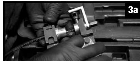
Para empalmar una manguera de combustible de nylon, necesitará configurar la herramienta KLEDGE-LOK™ de manera un poco diferente, una mandíbula KLEDGE-LOK™ estándar de 3/8" (ACR-106) y el conector de empalme de la línea de combustible de nylon KLEDGE-LOK™ correspondiente (FLR-002, FLR-003, FLR-004).
