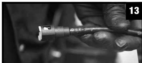
Pour les connecteurs rapides à 90 degrés, la procédure est la même, sauf qu'au lieu d'utiliser l'insert du connecteur rapide, il faut utiliser le porte-connecteur rapide à 90 degrés :
