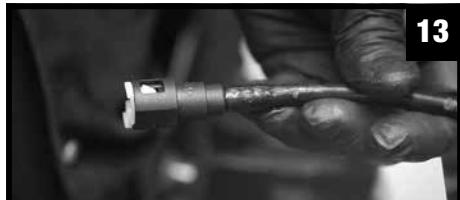
Para conectores rápidos de 90 grados, el procedimiento es el mismo excepto que en lugar del inserto del conector rápido, se usará un sujetador de conector rápido de 90 grados:
