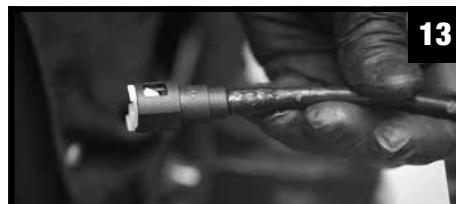
Bei rechtwinkligen Schnellkupplungen verläuft die Montage entsprechend, wobei anstelle des Schnellkupplungseinsatzes die Vorrichtung für 90°-Schnellkupplungen verwendet wird:
