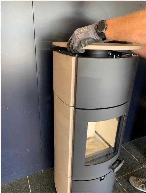
13. Setzen Sie nun die Keramik-Topplatte vorsichtig auf den Ofen auf. Durch Einstellen der Gewindestifte mit Hilfe eines Schlitzschraubenziehers kann die Platte ausgerichtet werden.
