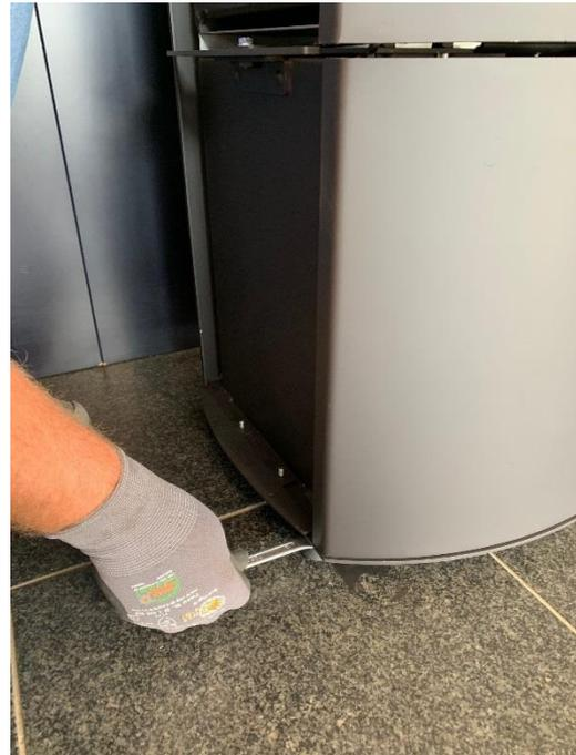
2. Nutzen Sie zur Ausrichtung die Höhenversteller im Fuß des Ofens. Diese lassen sich mit einem 13 Maulschlüssel einstellen.
