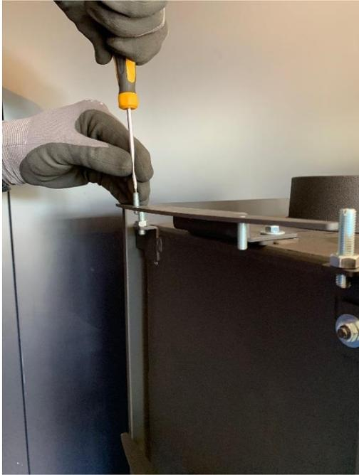
5. Drehen Sie nun zwei Gewindestifte (M5 x 20) soweit in den oberen Keramikhalter ein, dass diese mit der Oberseite bündig abschließen
