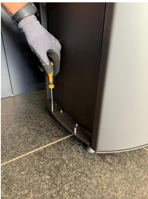
3. Vissez maintenant deux des vis sans tête (M5 x 20) dans le support inférieur en céramique jusqu'à ce qu'elles soient affleurantes avec le côté inférieur.
