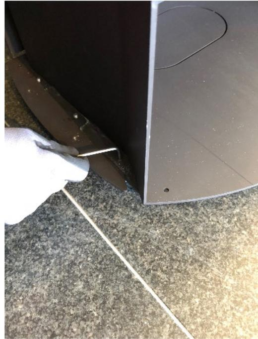
2. Nutzen Sie zur Ausrichtung die Höhenversteller im Fuß des Ofens. Diese lassen sich mit einem 4er Inbus verstellen. Alternativ ist dies auch mit einem 13 Maulschlüssel möglich.
