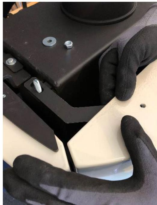
16. Fixieren Sie nun mit Hilfe der Halterungen die Frontverkleidung. Positionierung der Halterung siehe Bild. Wiederholen Sie diesen Schritt auf der anderen Seite der Frontverkleidung.
