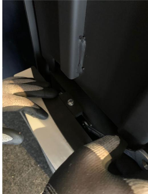
10. Falls Sie nun feststellen, dass der Keramikhalter nicht plan auf der Keramik und/oder auf der Auflage am Korpus aufliegt, lösen Sie die Verschraubung am Korpus und verschieben Sie diesen entsprechend nach unten.
