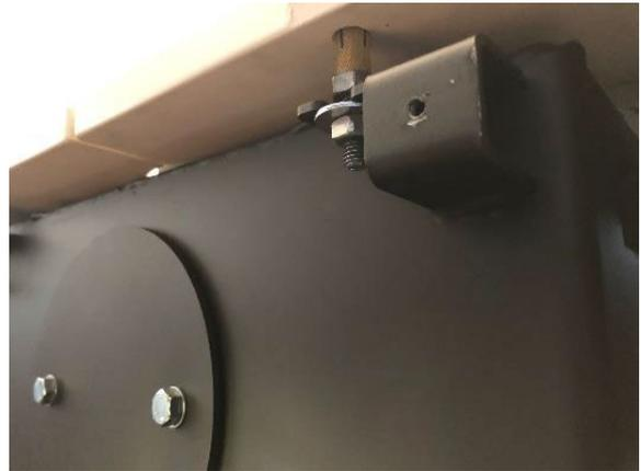
22. Befestigen Sie die Topplatte an der Rückseite des Ofens wie auf dem Bild gezeigt. Die Montage der Topplatte aus Stahl erfolgt gleichlautend. Über die zwei Gewindestifte, die auch zur Befestigung der Frontverkleidung dienen, kann die Topplatte bei Bedarf noch ausgerichtet werden.
