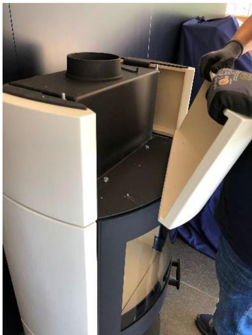
15. Setzen Sie nun die Frontverkleidung (Einbau des Teefachs wird später erklärt) so auf den Ofen auf, dass die Positionierungsbolzen am Ofen vollständig in das Bauteil eingeführt sind.
