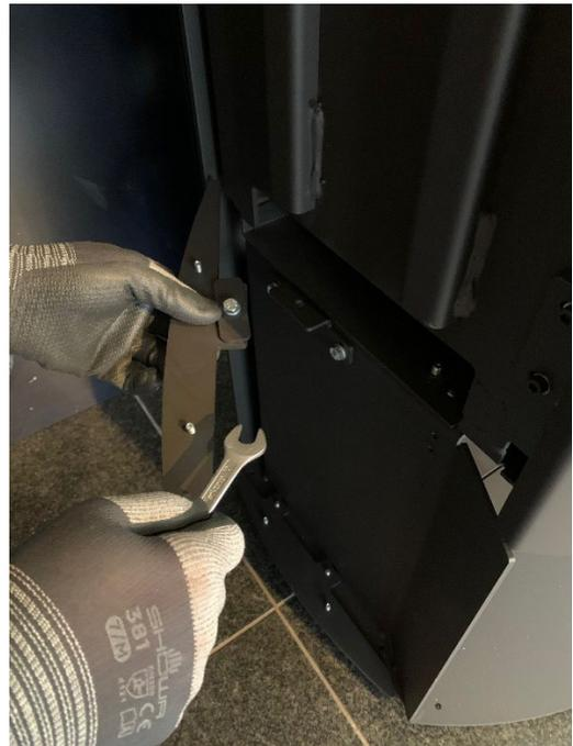
6. Lösen Sie nun die Verschraubung des zweiten Halters und legen Sie diesen zur Seite.
