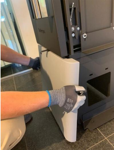
4. Trek de luchttoevoerschuif volledig uit de kachel voordat u de onderste frontplaat bevestigt.
