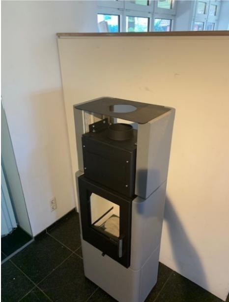
19. Controleer de uitlijning van de bovenzijde van de kachel door de bovenplaten van de kachel erop te plaatsen. Het moet mogelijk zijn om ze plat op de tegels te leggen.
