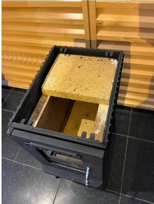
15. Legen Sie nun die größere der beiden Umlenkplatten quer auf die bereits eingesetzten Platten auf und schieben Sie diese an die Rückwand des Ofens.
