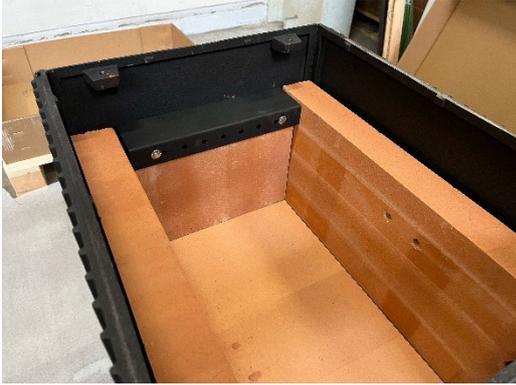
15. Setzen Sie nun die Sekundärluft ein. Diese muss oben bündig mit den Seitenplatten aus Schamotte abschließen.
