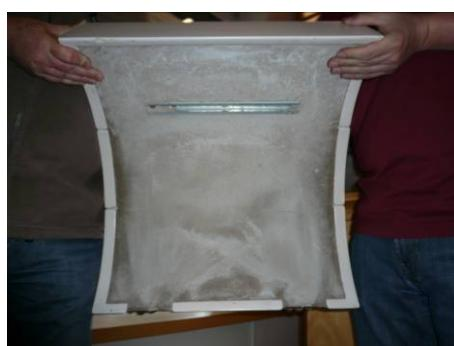
**D:** In der Innenseite der Keramik ist eine Armierung (Schiene) eingearbeitet. Tragen Sie die Keramik bitte mit der Öffnung für die Schiene nach oben gerichtet und in Richtung Ofen zeigend. Heben Sie die Keramik bis knapp unter die oberen Konvektionsrohre und senken Sie diese vorsichtig ab bis die Öffnung auf Höhe der Schiene ist. Berühren Sie den Ofen nur mit Vorsicht, um Schäden an der Keramik oder am Ofen zu vermeiden.
