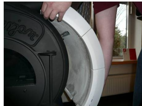
**D:** Mit ein wenig Druck die Öffnung gegen die Schiene pressen bis die Vorrichtung einrastet/klickt.
