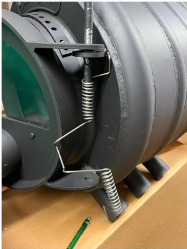
Ziehen Sie nun den Bolzen soweit nach oben aus seiner Führung heraus, bis Sie die Feder entsprechend des Fotos einsetzen können. Die mittlere Halterung der Feder muss um den Türrahmen greifen.
