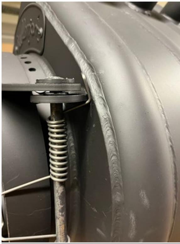
Mit etwas Kraft führen Sie den Türbolzen zurück in die Ursprungposition. Als Letztes bitte den Sicherungsring wieder aufbringen.
