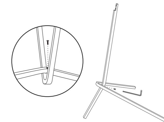
**3** 支柱の中央を短ネジで組み立ててください。
