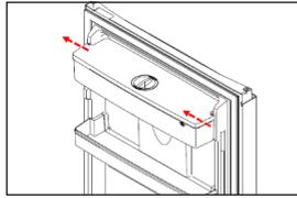
2. Instale la pieza de la caja de almacenamiento de agua, colóquelo en el orificio de la puerta, luego alinee el interior de la puerta, luego presione la caja de almacenamiento de agua en 30° por encima del plano horizontal.
