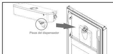
3. Vierta agua en la pieza de la caja de almacenamiento. En primer lugar, gire la tapa en sentido contrario a las agujas del reloj y tire. En segundo lugar, vierta agua en la caja de almacenamiento, observando la línea límite y por último, cúbrala.
