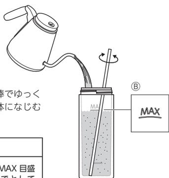
3 図の様にツマミを上げたまま、飲み口・プランジャーセットを取り付け、4分間蒸らします。
