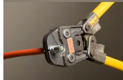
Die Pressung ist in Ordnung, wenn in der mittleren Pressrille ein Durchmesser von 16,0 - 16,3 mm gemessen werden kann.
