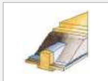
Belastbare Überschüttung der Balkenlage bei verschieden aufgebauten Holzbalkendecken
