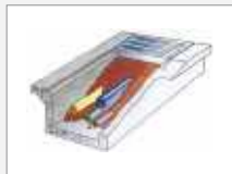
Verfüllung von Kabel- und Rohrkämen
