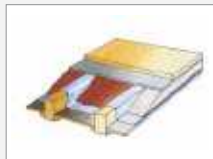
... im Balkenzwischenraum mit durchgehender Trittschalldämmung
