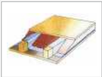
Trockenschüttung in Holzbalkendecke im Balkenzwischenraum ohne Trittschalldämmung
