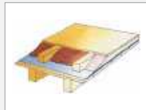
Dämmung zwischen Lagerhölzern auf Holzbalkendecke
