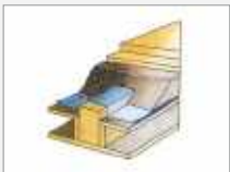
Belastbare Überschüttung der Balkenlage bei verschieden aufgebauten Holzbalkendecken
