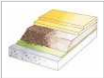
Belastbare Schüttung auf Massivdecke mit Trockenestrichsystem
