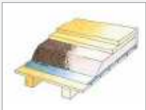
Belastbare Schüttung auf Holzbalkendecke mit Trockenestrichsystem
