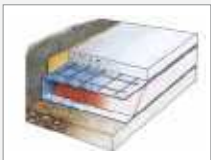
Wärmedämmschüttung gegen Erdreich* *entspricht nicht Ausführung nach Ö-Norm
