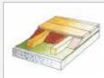
Dämmung zwischen Lagerhölzern auf Massivdecke
