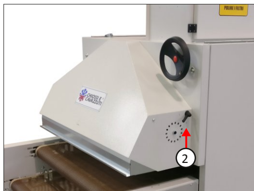
Asso 950: leva nella parte laterale della cappa di aspirazione in uscita
