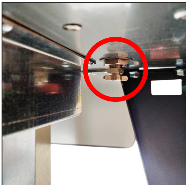
Il rubinetto sotto al serbatoio dell'aria è posto nella parte inferiore della macchina vicino all'impilatore, sul lato destro guardando dal pannello comandi.
