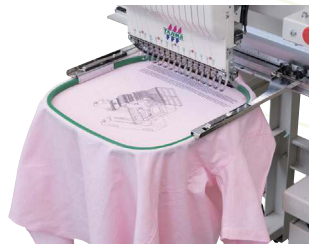
▲Tubular Frame(Standard) (360mm x 500mm)
