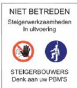
Steigerkaarthouder, zichtbaar tijdens steigerbouwwerkzaamheden
