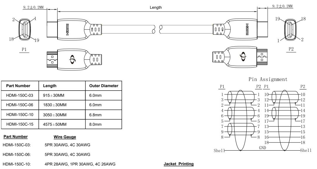
HDMI-150C-15: 4PR 25AWG, 1PR 30AWG, 1C 26AWG, 3C 30AWG
