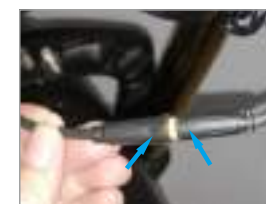
11. Schließen Sie das Lichtkabel an (Hinweis) dass die Richtung des Pfeils muss entsprechen)
