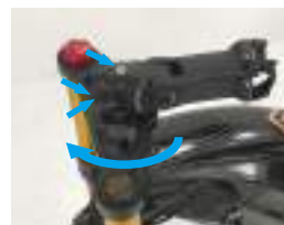
1. Regolare la parte superiore e sinistra e destraviti per ruotare la regolazione. Alzare 180 gradi e fissarlo al luogo.
