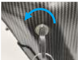
Apri il blocco della batteria
