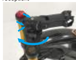
1. Ajuster le haut et gauche et droite Rotation des vis réglables Riser 180 degrés et fixeLocalisation
