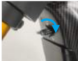
Drehen Sie den Knopf im Uhrzeigersinn, um die Batterie herauszulassen
