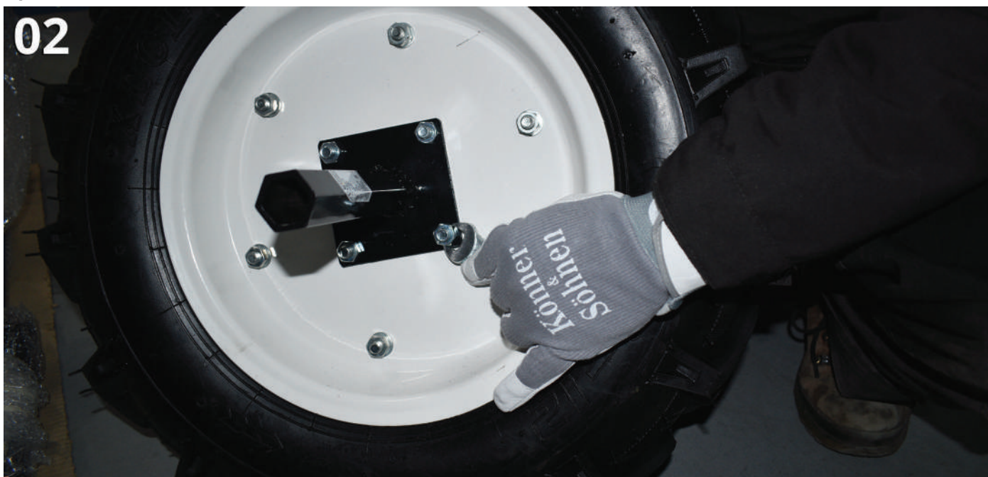
Rys.2. Przymocować koło transportowe do osi za pomocą śrub, nakrętek i podkładek.
