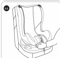
• Asegúrese de que la cinta abdominal pase por las guías (O) a ambos lados de la silla (ver figura 6.7). Compruebe que la cinta no está torcida y ténsela tirando del cinturón diagonal hacia arriba.
