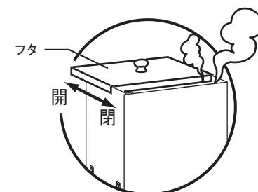
※煙中はときどき、本体の中を点検し煙材の燃え方や食材に異常がないか確認してください。
