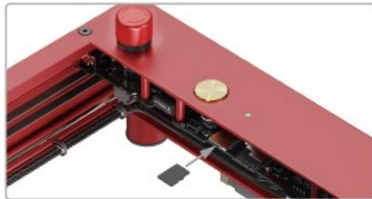
**注意:** xTool D1 Pro を使用する前に TF カードを挿入してください。そうしないと、Wi-Fi 接続ベースの処理、オフライン処理、処理プレビューでのフレーミングなど、一部の機能が失敗する可能性があります。
