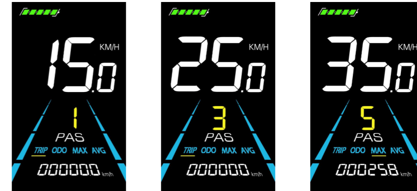
Figure 5-4 PAS level display interface
