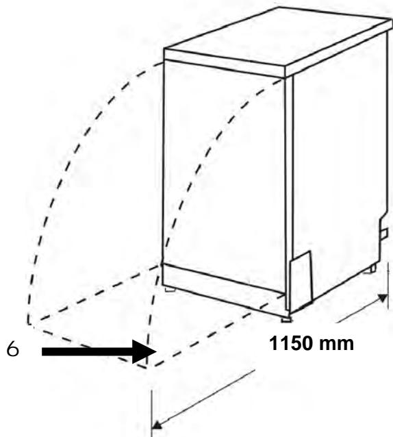
La hauteur et la position horizontale correctes du lave-vaisselle peuvent être réglées avec les pieds réglables 1 et 2 (par vissage ou dévissage). Dans tous les cas, l'appareil ne doit pas être incliné de plus de 2°.
