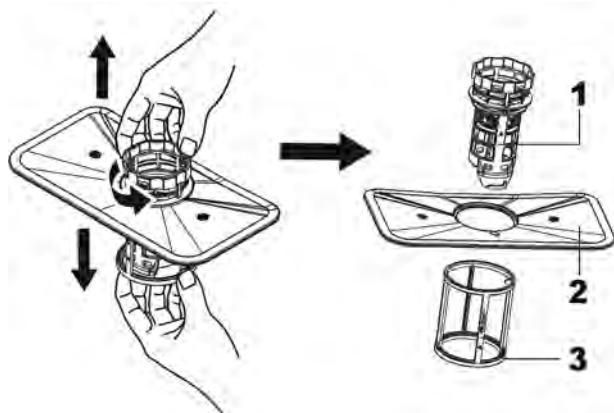
Zum Reinigen des Grobfilters und des feinen Filters verwenden Sie eine Geschirrspülbüste.
