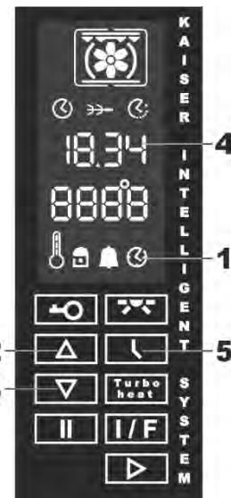
Wenn das Gerät an das Stromnetz angeschlossen ist oder ein Stromausfall aufgetreten ist, blinkt automatisch das Symbol 1 für Uhrzeit.
