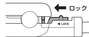
上下のプレートを閉じた状態でロックスイッチをスライドさせると、閉じた状態で収納できます。
