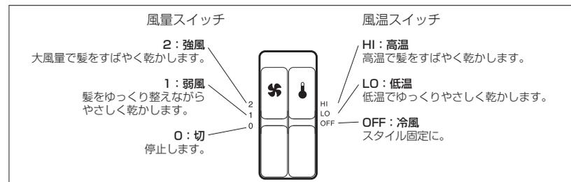
3. 使用後は、スイッチを OFF (0) にして、電源を切ります。電源プラグをコンセントから抜きます。
