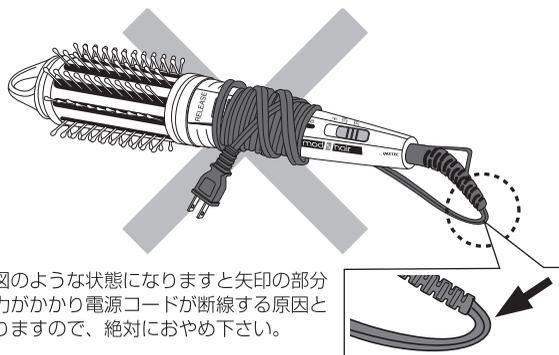
右図のような状態になりますと矢印の部分に力がかかり電源コードが断線する原因となりますので、絶対におやめ下さい。
