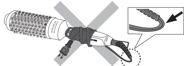
右図のような状態になりますと矢印の部分に力がかかり電源コードが断線する原因となりますので、絶対におやめ下さい。
