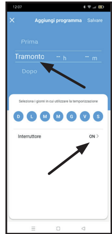
Selecciona “Puesta del Sol”, antes o después y con que anticipación o aplazamiento, los días de la semana en los que quieres actuar el programa y luego ON u OFF. Finalmente pulsa “Guardar”.
