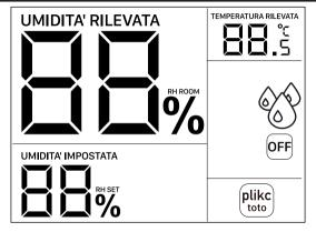
Quando "l'UMIDITA' RILEVATA" è più bassa "dell'UMIDITA' IMPOSTATA" il dispositivo spegne l'impianto ad esso collegato. Sul display, quindi, appare il simbolo "OFF".
