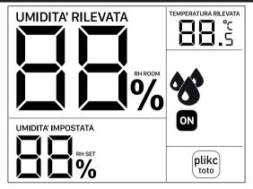
Quando "l'UMIDITA' RILEVATA" è più alta "dell'UMIDITA'IMPOSTATA" il dispositivo accende l'impianto ad esso collegato. Sul display, quindi, appare il simbolo "ON".
