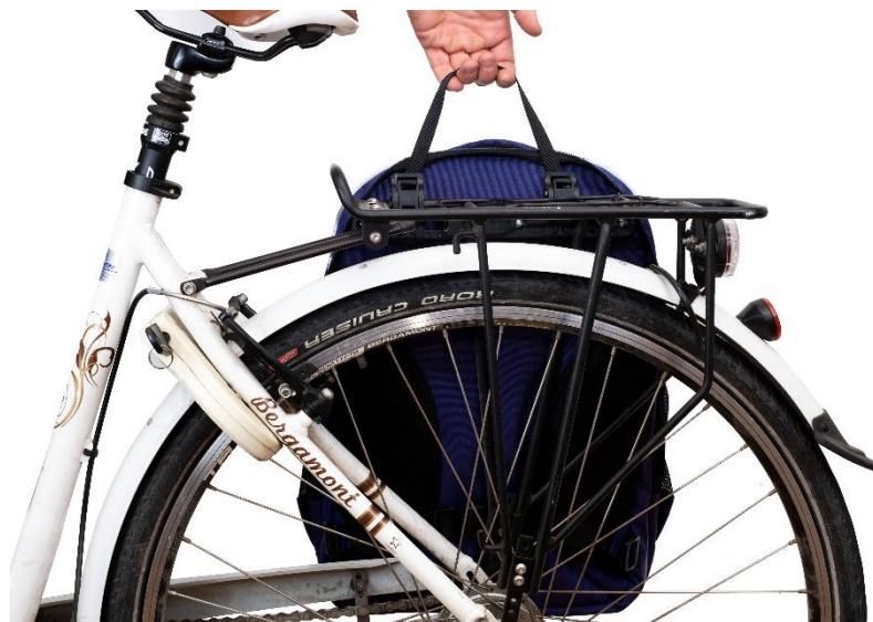
Abbildung 12: Die Gepäckträgerhaken öffnen sich, wenn am Band gezogen wird
