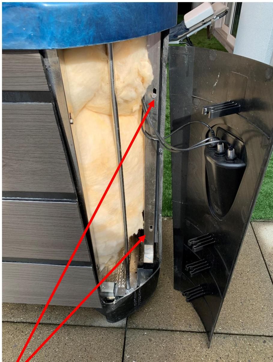
Lorsque le revêtement d'angle a été retiré, les vis peuvent être retirées de la paroi latérale. Deux vis sont montées de chaque côté.
