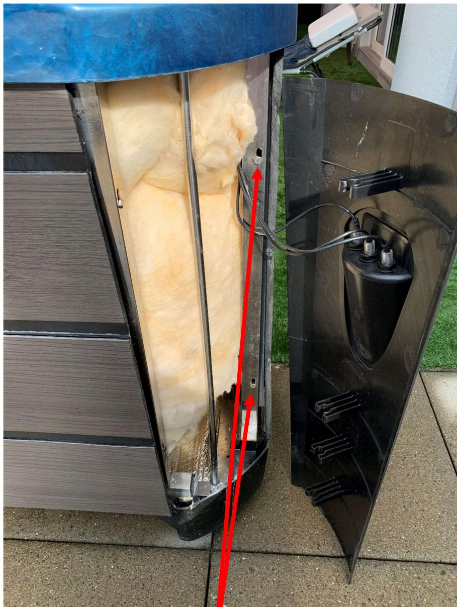
Una volta rimosso il pannello angolare, **le viti** possono essere rimosse dalla parete laterale. Ci sono due viti su ogni lato.
