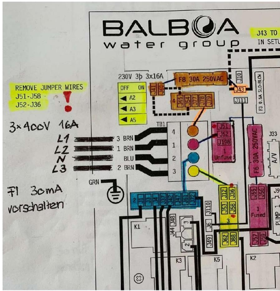
Folgende Jumper Brücken dürfen nicht verbunden sein, bei Bedarf sind sie zu entfernen:
