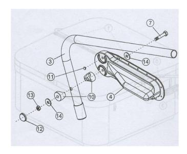
Schritt 2: Teil identisch wie auf der anderen Seite positionieren und Schrauben einsetzen. Hier kann man die Höhe, auf der die Thermoabdeckung sich dann befindet, wählen.
