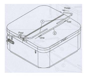
Schritt 4: Positionieren Sie den Coverlift und Schrauben einsetzen.
