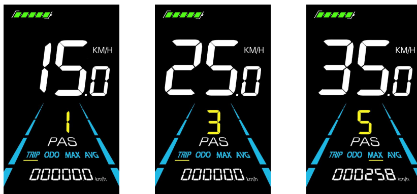
Figure 5-4 PAS level display interface
