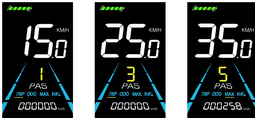
Figure 5-4 PAS level display interface
