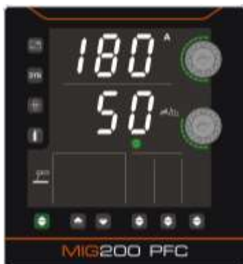
(Lichtbogenstärke auf dem digitalen HD-Display auswählen)
