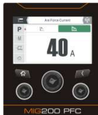
(Lichtbogenstärke auf dem LCD-Display auswählen)
