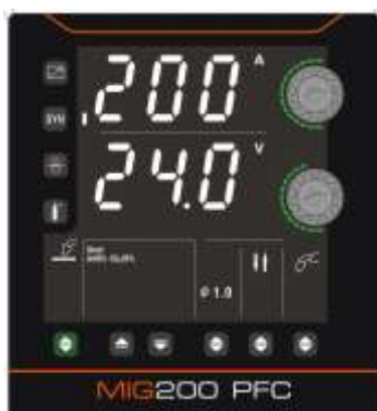
(Einstellung des Schweißstroms)
