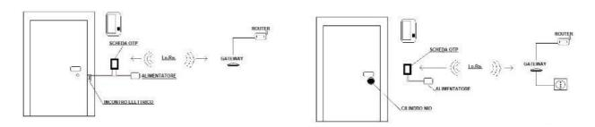
Il sistema NIO ZEN, può funzionare anche on-line, ovvero con l'ausilio di un gateway, che attraverso una comunicazione radio a lunga distanza (Lo.Ra.), può gestire centinaia di porte, e comandare l'apertura di varchi anche sprovvisti di tastiera. Sarà infatti possibile utilizzare l'applicazione per controllare l'apertura di qualsiasi porta o varco nell'impianto.
