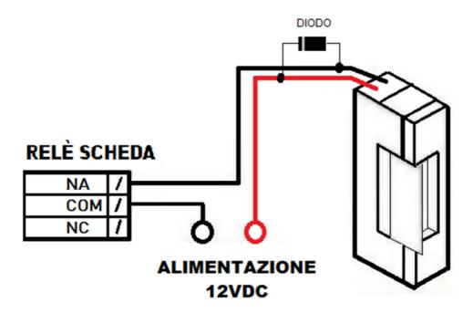
Collegare i fili di ritorno del dispositivo esistente (elettroserratura o serratura motorizzata) al relè 1 prevedendo un diodo per salvaguardare la scheda dal rischio di ritorno di corrente elettrica
