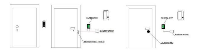
In figura si evidenzia l'esterno della porta, con il tastierino e due possibili controlli della porta, con incontro elettrico o con cilindro motorizzato NIO. La tastiera e la scheda OTP sono sempre collegate tra di loro come mostrato in precedenza. All'interno dell'appartamento/camera, si dovranno passare altri due fili nel caso di installazione di incontro elettrico. Un filo direttamente dall'alimentatore all'incontro elettrico, ed uno che viene spezzato dal relè della scheda OTP.
