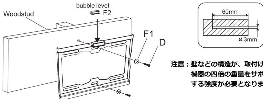
注意：壁などの構造が、取付ける機器の四倍の重量をサポートする強度が必要となります。
