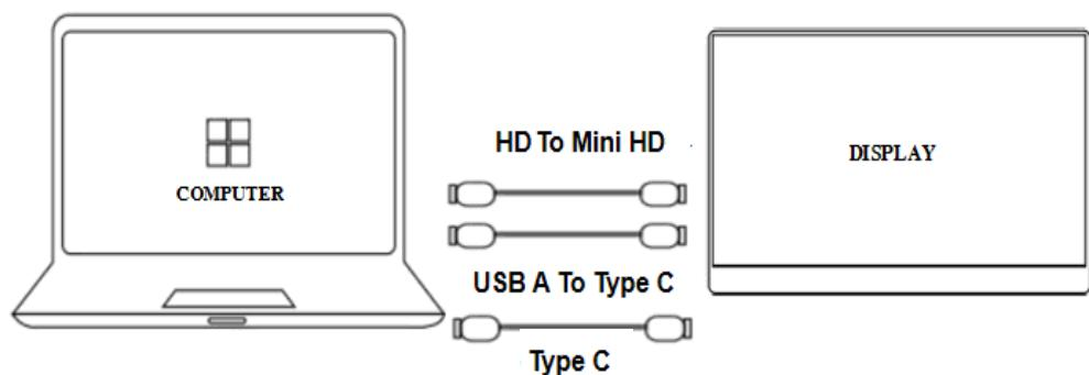
本製品は miniHDMI ポートを搭載しています。本機側 miniHDMI とコンピューター側 HDMI ポートを接続してください。また付属の Type-C ケーブルまたは USB type-A to C ケーブルを電源供給用に接続します。USB、Type-C ポートのないコンピューターの場合は 5V/2A 以上の外部電源に接続する必要があります。
