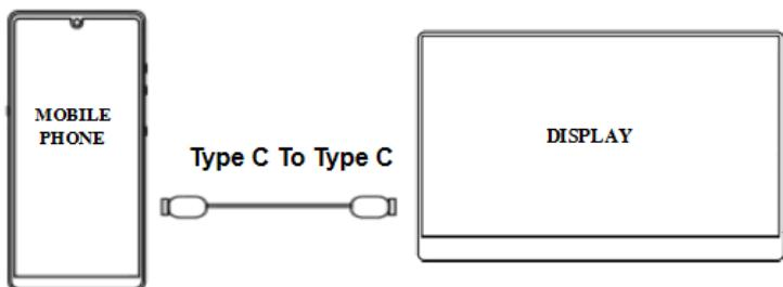
※Type-C ケーブルを使用してスマートフォンと接続できます。スマートフォン側の設定に応じてスマートフォンの画面やユーザーインターフェイスを表示することができます。
