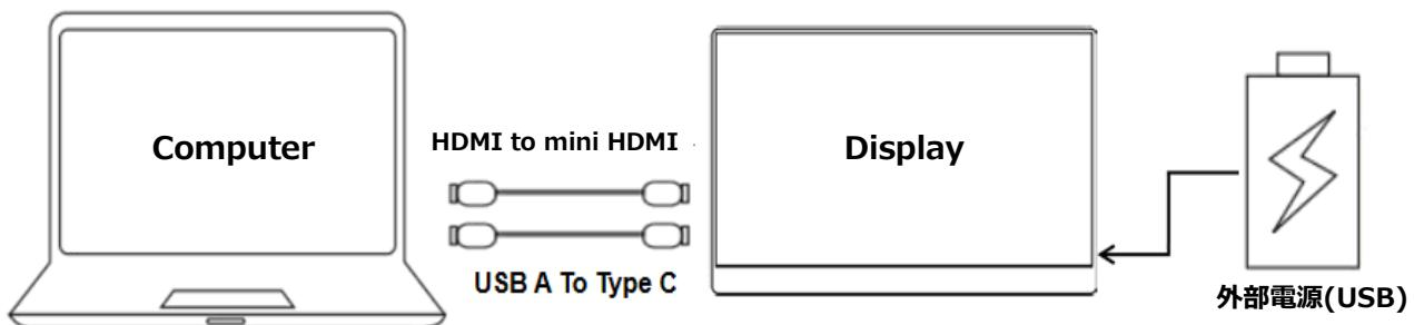
本製品は miniHDMI ポートを搭載しています。本機側 miniHDMI とコンピューター側 HDMI ポートを接続してください。また電源供給用に電源アダプターまたは USB-A to Type-C ケーブルを接続します。
