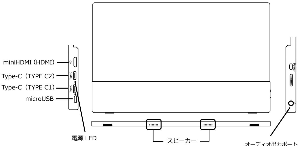
**Type-C ポート x 2 :** Type-C 交換デバイス専用です。
